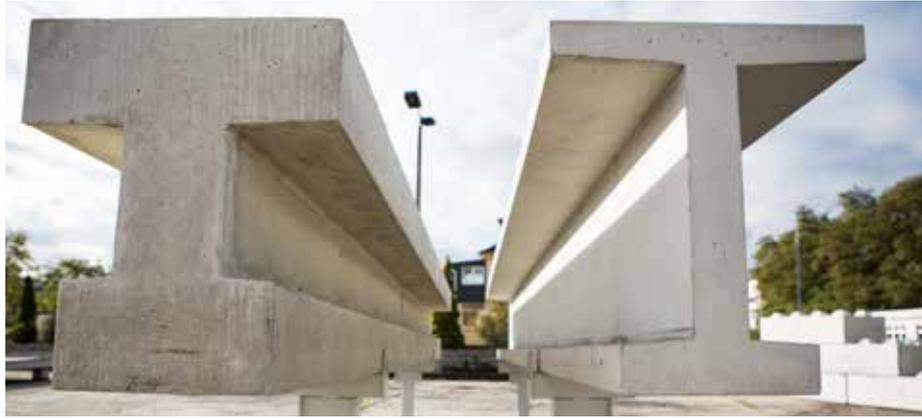
Vergleich zwischen Stahl- und Carbonbeton (re.).
